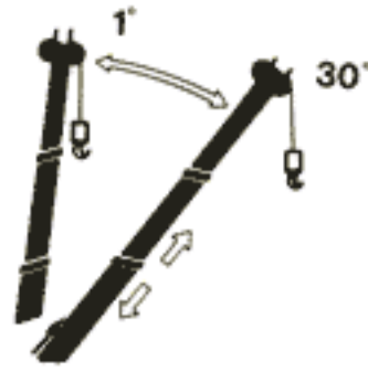
■ 50.0mブーム+10mスーパーラフィングジブ (A 性能)
